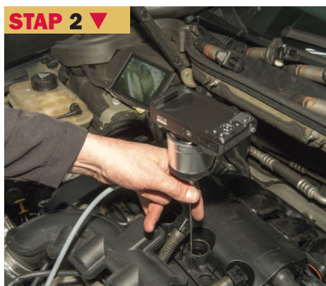
STAP 2 ▼ Controleer - eventueel met een endoscoop - welk kleppen het minst vervuild zijn. Draai de krukas totdat de minst vervuilde kleppen open staan. Die worden het minst vervuilde kleppen open staan. Die worden het minst vervuilde kleppen open staan. Die worden het minst vervuilde kleppen open staan. Die worden het minst vervuilde kleppen open staan.
