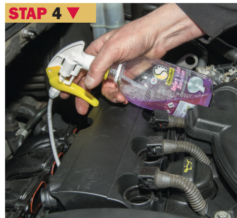
STAP 4 ▼ Vul de gesloten inlaatpoorten zo vol mogelijk met Inlet Valve Solution.
